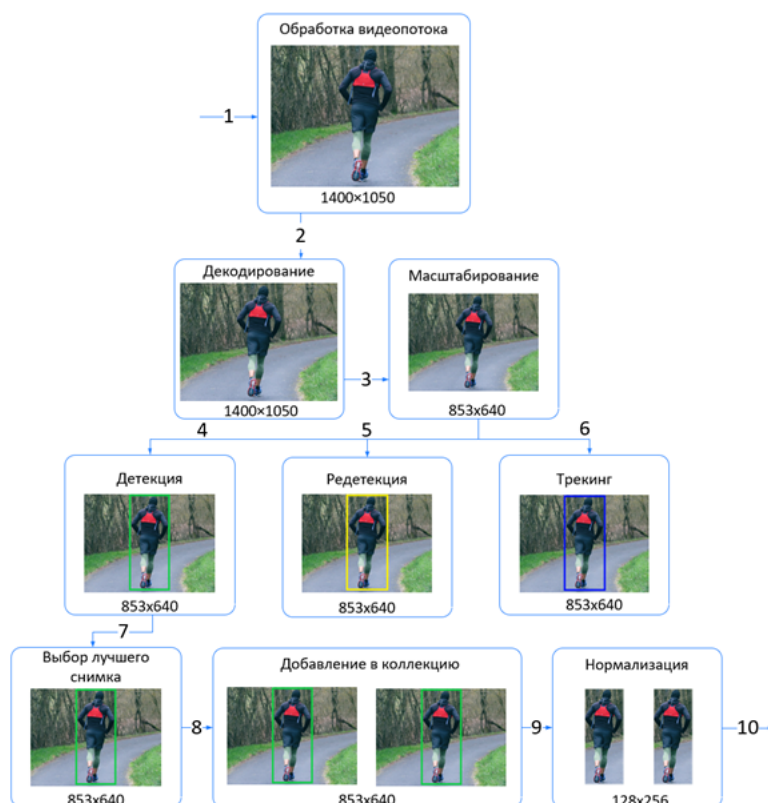
Рис. 2: Схема работы FaceStream с телами
